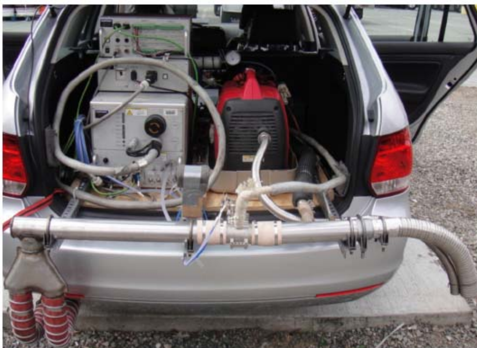
Рис. 2. Оборудование и монтаж для проведения испытаний в дорожных условиях.
